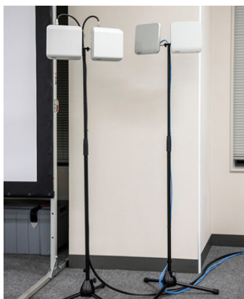
受信機も部屋のレイアウトによって移動できるようにスタンドに取り付けている。
