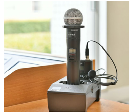
教壇に置かれた ULX-D のハンドヘルドマイク ULXD2/SM58 とポディーパック ULXD1。マイクを挿している台は充電器になっており常時使用できる。
